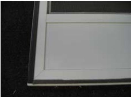
Sockelblech einlegen, Sprossenprofil festschrauben.
