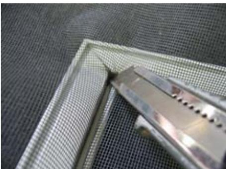
Wie beim Einrollen des Gummikeders wird in einer Ecke des Spannrahmens begonnen. Mit äußerster Vorsicht das Gewebe dicht am Gummikeder mit einem Teppichmesser ringsum abschneiden.
