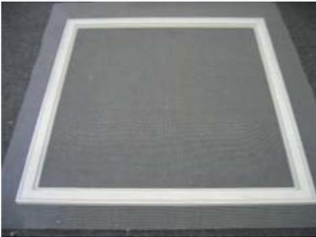
Rahmen mit der Innenseite nach oben (Kederkanal und Bürstenkanal sichtbar) auf den Montagetisch legen.
